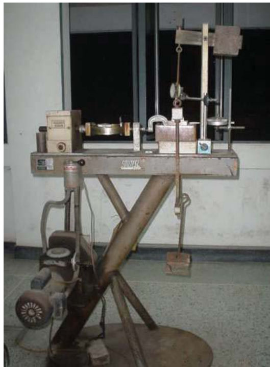
รูปที่ 3.8 เครื่องมือการทดสอบแรงเฉือนแบบโดยตรง (Direct Shear Test)
