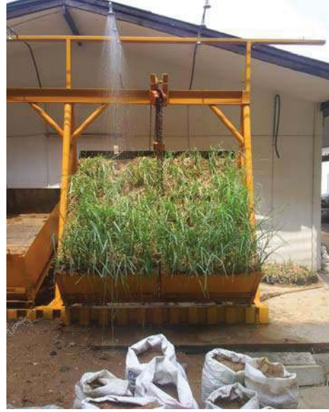
รูปที่ 4.7 แสดงผลการทดลอง โดยใช้โมเดลจำลองที่มุม 45 องศา
