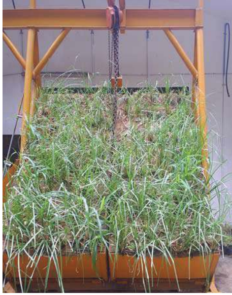
รูปที่ 4.7 แสดงผลการทดลอง โดยใช้โมเดลจำลองที่มุม 45 องศา
