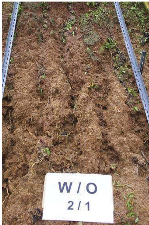
รูปที่ 4.12 เปรียบเทียบหลังการทดลองระหว่างแปลงที่ไม่ปลูกหญ้าแฝกกับปลูกหญ้าแฝก
