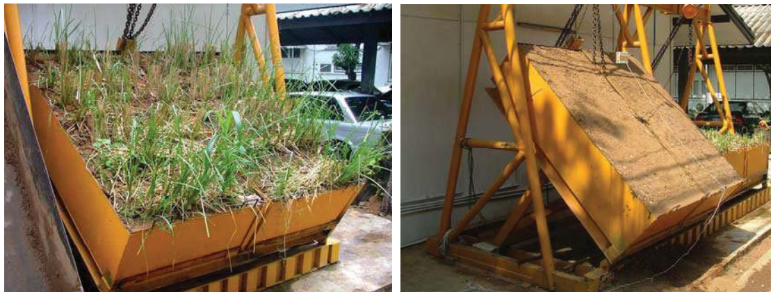
รูปที่ 3.10 โมเดลจำลองการชะล้างพังทลายของดินที่มีการปลูกหญ้าแฝก และไม่มีการปลูกหญ้าแฝก
