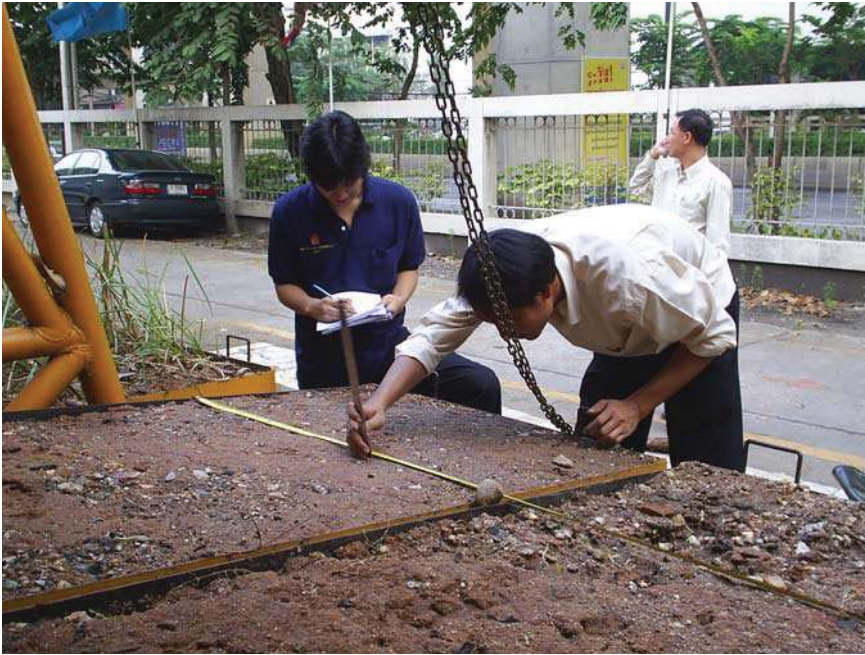
รูปที่ 3.17 ตรวจวัดปริมาตรดินที่ถูกชะล้าง
