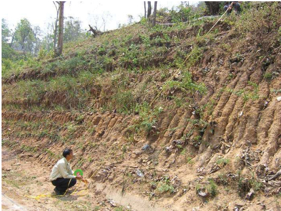
รูปที่ 3.21 แสดงวิธีการวัดมุมลาดเอียงของพื้นที่ที่จะทำการทดลองอย่างคร่าว ๆ
