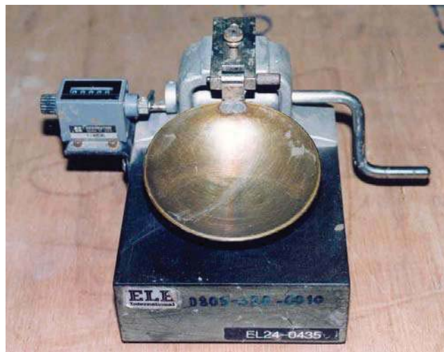
รูปที่ 3.5 เครื่องมือทดสอบ Atterberg Limit
