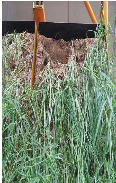
รูปที่ 4.7 แสดงผลการทดลอง โดยใช้โมเดลจำลองที่มุม 45 องศา
