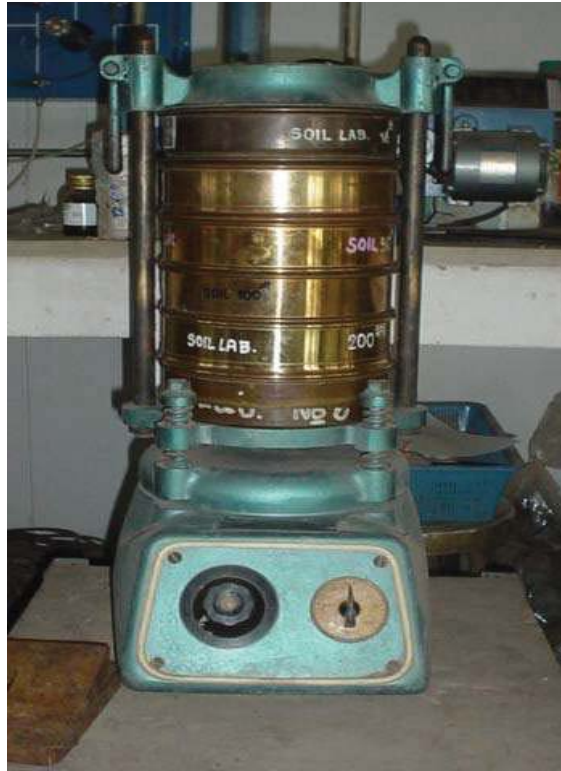
รูปที่ 3.4 ชุดตะแกรงร่อนขนาดต่างๆทดสอบหาขนาดของเม็ดวัสดุ
