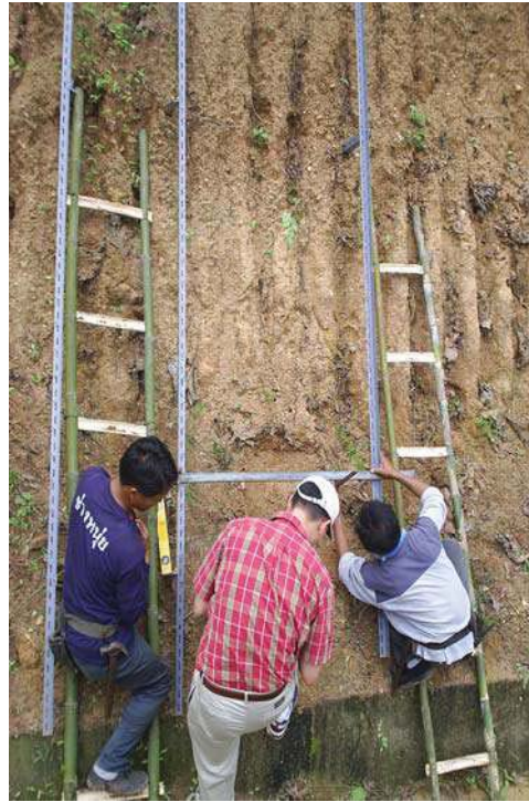
รูปที่ 4.11 แสดงการทดลองในสนามในแปลงที่ไม่ได้ปลูกหญ้าแฝกและการวัดปริมาณการชะล้าง
