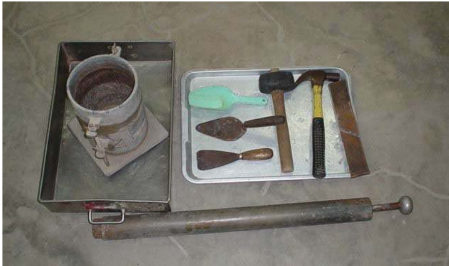
รูปที่ 3.6 เครื่องมือการทดสอบการบดอัดแบบสูงกว่ามาตรฐาน (Modified Compaction Test)
