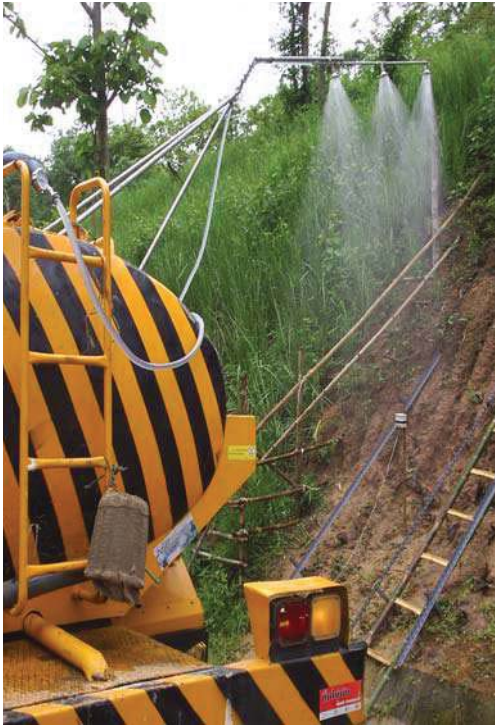
รูปที่ 4.11 แสดงการทดลองในสนามในแปลงที่ไม่ได้ปลูกหญ้าแฝกและการวัดปริมาณการชะล้าง
