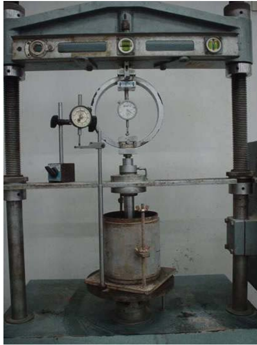
รูปที่ 3.7 เครื่องมือการทดสอบหาค่า CBR
