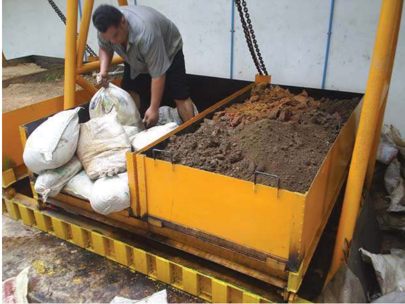
รูปที่ 3.11 การเตรียมดินใส่ลงในโมเดลจำลอง
