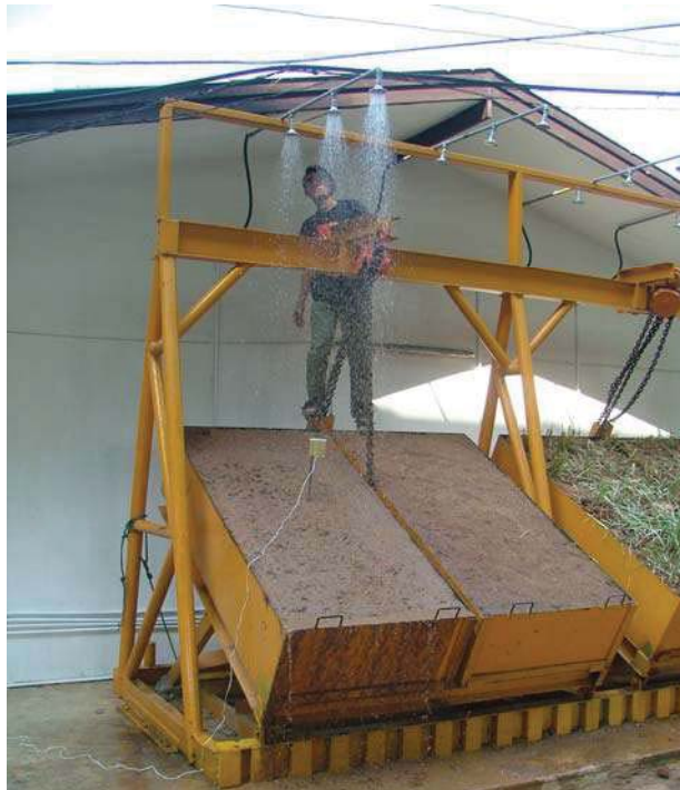
รูปที่ 3.16 ทำการเปิดน้ำเป็นเวลา 30 นาที
