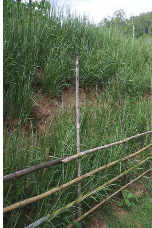
รูปที่ 4.10 แสดงการทดลองในแปลงที่ปลูกหญ้าแฝกในทางหลวงหมายเลข 1095 กม. 85+650 จ.แม่ฮ่องสอน ที่อายุ 10 เดือน
