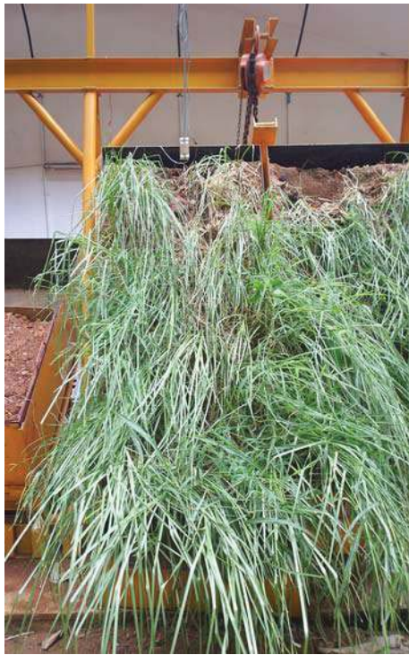
รูปที่ 4.7 แสดงผลการทดลอง โดยใช้โมเดลจำลองที่มุม 45 องศา
