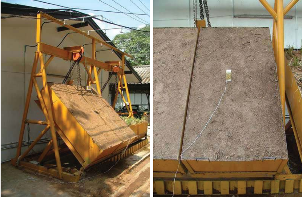
รูปที่ 3.15 ปรับระดับโมเดล และทำการติดตั้ง Rain Gauge
