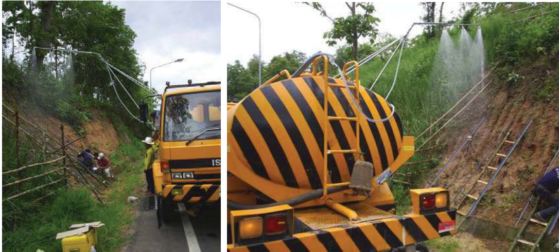
รูปที่ 3.26 รถบรรทุกน้ำที่ติดตั้งอุปกรณ์จ่ายน้ำฝน
