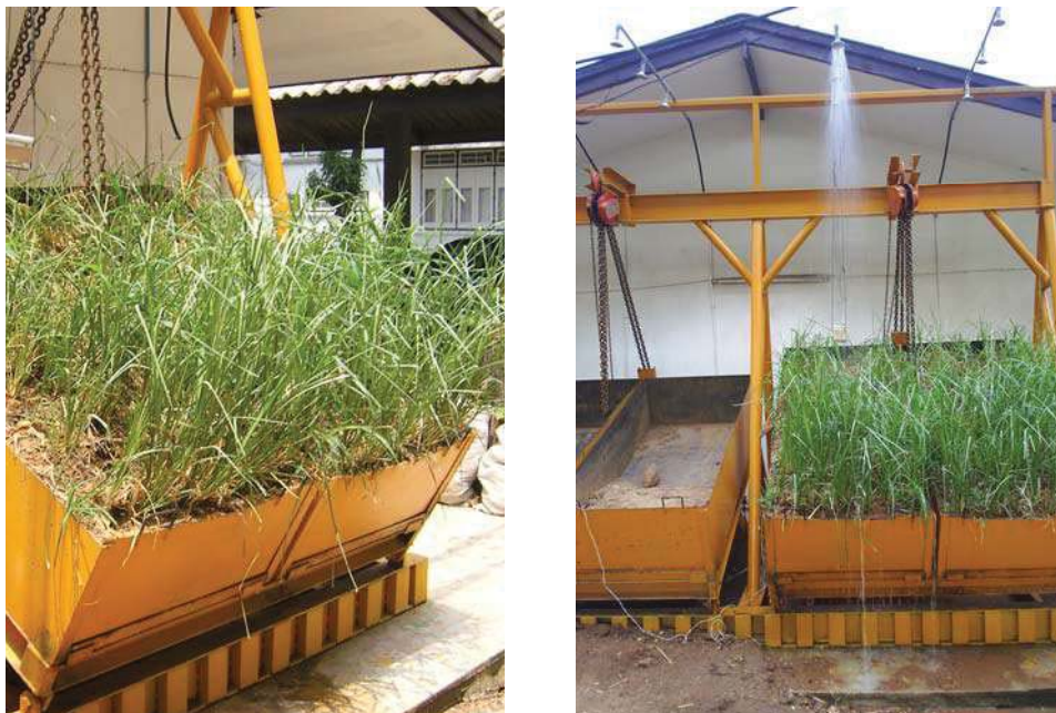
รูปที่ 4.6 แสดงผลการทดลองโดยใช้โมเดลจำลองที่มุม 30 องศา
